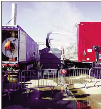
Unité mobile de distillation en mini-caisson de 10 m<sup>3</sup>
