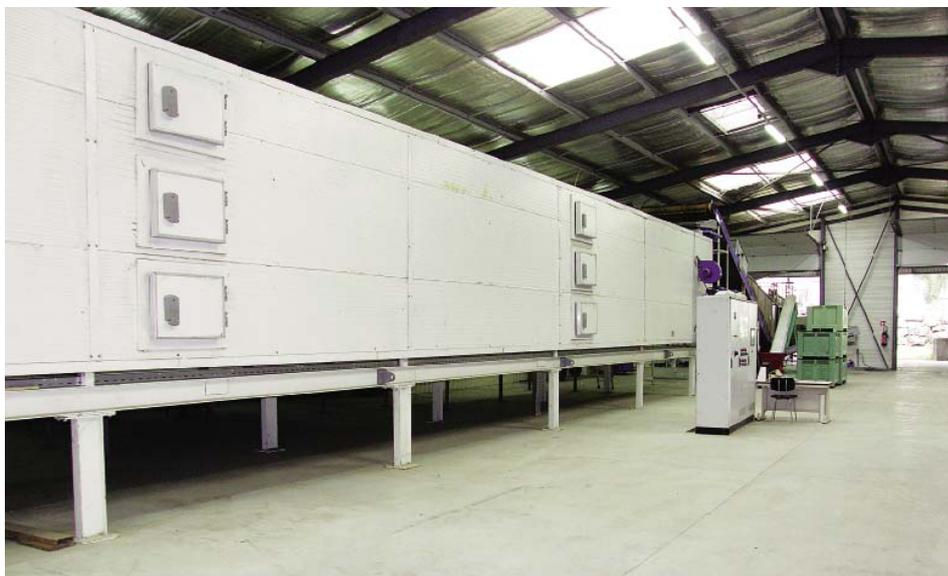
Figure 1 : Four de séchage
